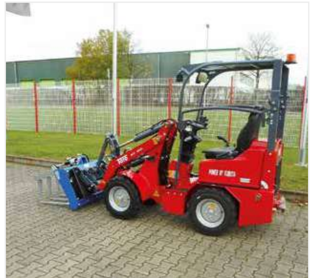
Palettengabel hydraulisch UPF25H
