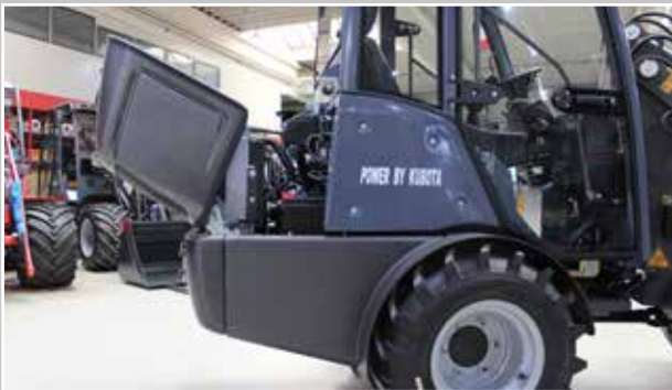
Weit zu öffnende Motorhaube für noch einfacheren Service
