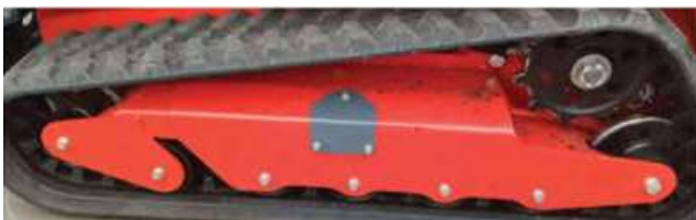
Robuster Kettenantrieb, bodenschonend mit engem Wendekreis
